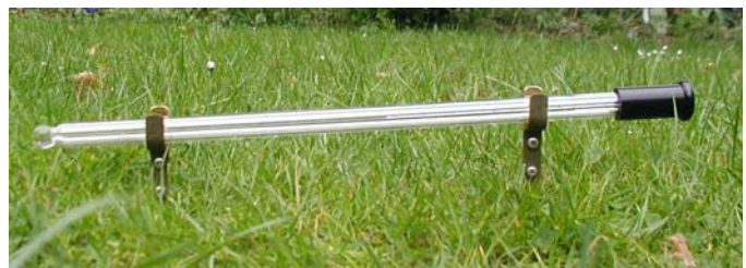
ภาพ 4.9 เทอร์โมมิเตอร์ตรวจวัดอุณหภูมิต่ำสุดของอากาศ
