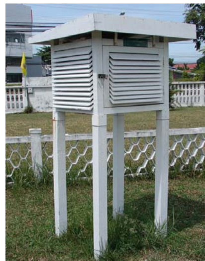
ภาพ 4.7 เรือนเทอร์โมมิเตอร์ หรือตู้สกรีน แบบ Stevenson
